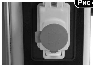
Крышка кнопки аварийного останова, для остановки станка стукните по крышке.
