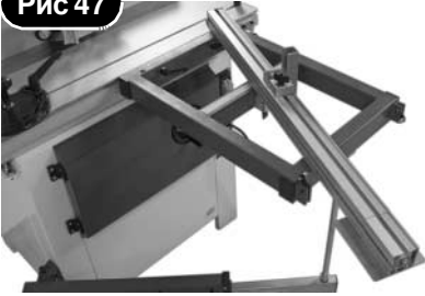
Упор рамы удлинения стола, установленный под углом 45°
