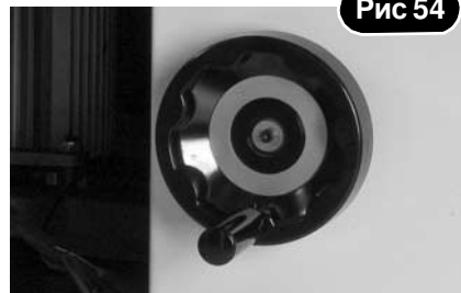
Маховик установки угла наклона шпинделя, расположен на передней стороне станка
