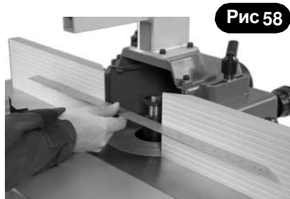
Приложите линейку к упору и проверьте, расположение его частей вдоль одной прямой
