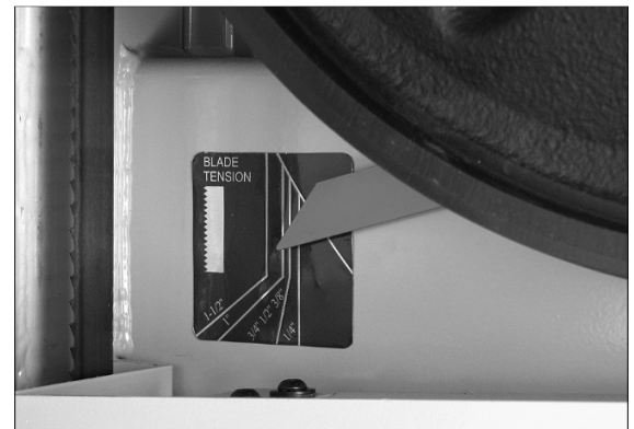
Рис. 25: шкала натяжения полотна
