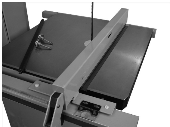
Рис. 15: установка упора параллельно ленточной пиле
