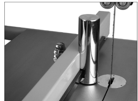
Рис. 33: штифт для продольной распиловки
