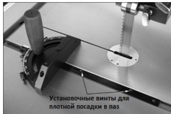
Рис. 34: настройка приспособления для распила под углом
