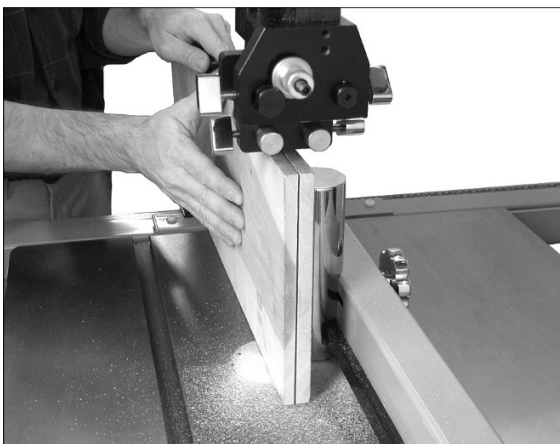
Рис. 44: штифт для продольной распиловки
