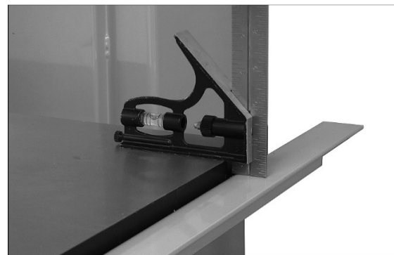
Рис. 5: выравнивание задней направляющей
