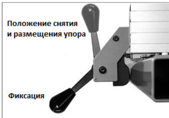
Рис. 7: положения рычага упора
